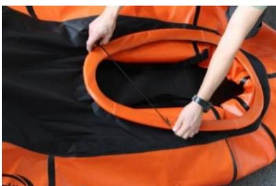
Ist der Alu-Süllrand vollständig in Position wird die Befestigungsschnur erst hinten überkreuzt und dann nach vorne um den Süllrand gelegt. Der Gummi fixiert das Cockpit dann am Süllrand.
