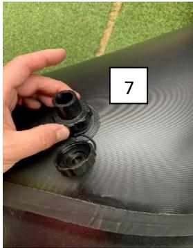
Zur **finalen Druckerzeugung** noch einige Male mit dem Mund nachpusten. Dafür gibt es einen (von uns stets desinfizierten) Adapter (7), der sich auf das Befüll-Ventil aufschrauben lässt. Das Rückschlagventil verhindert dabei den Luftaustritt.
