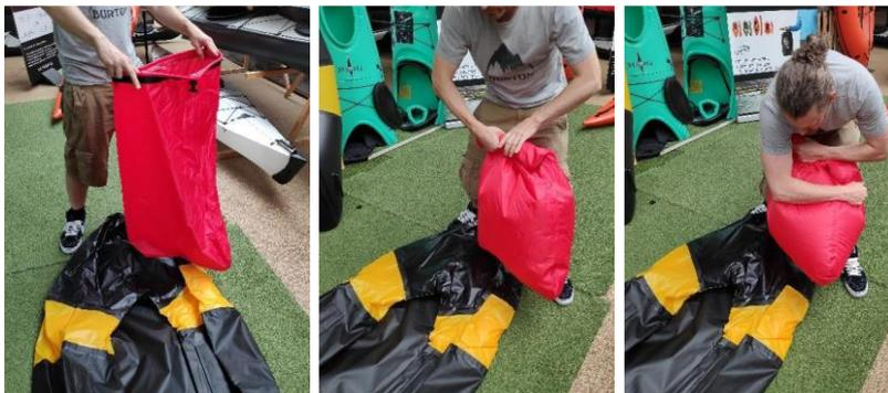
Mit dem Befüllsack wird jetzt die Luft ins Boot gepumpt. Das ist gewöhnungsbedürftig, geht aber gut. Den Befüllsack nach oben ziehen, langsam schließen und dann zuwickeln. Die Luft wird im Sack „gefangen“. Nun den Befüllsack nach unten zusammenfallen/rollen/drücken, die Luft wird ins Raft gepresst.
